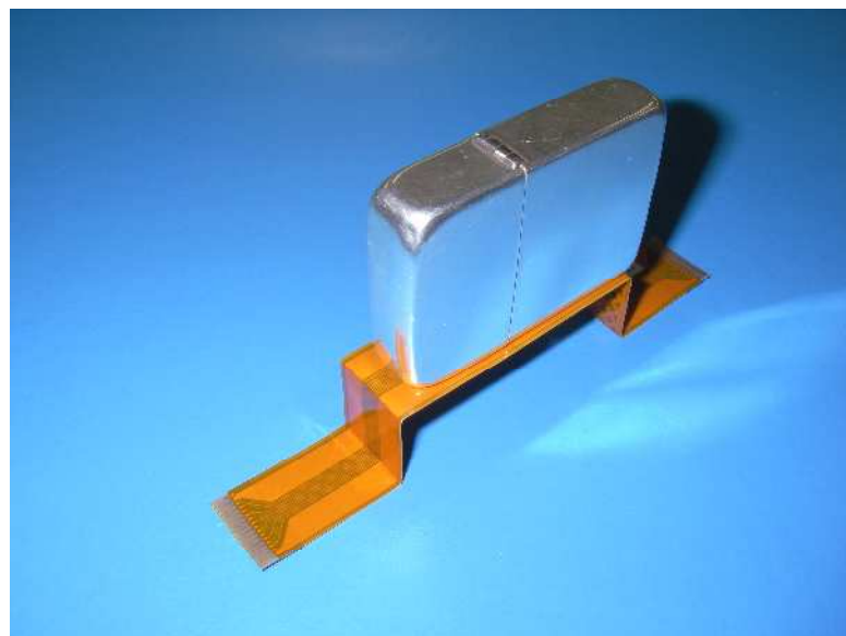
凸凹形状(ブリッジモデル) 荷重 = 0.7 N (70 g) → 形状保持
